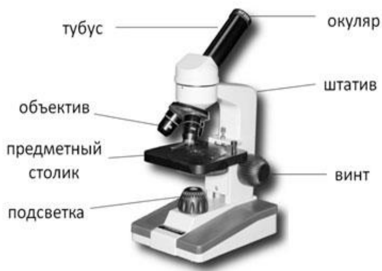
Рис.2 «Строение светового микроскопа»
