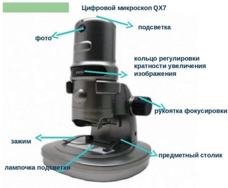
Рис.3 «Строение цифрового USB-микроскопа»
